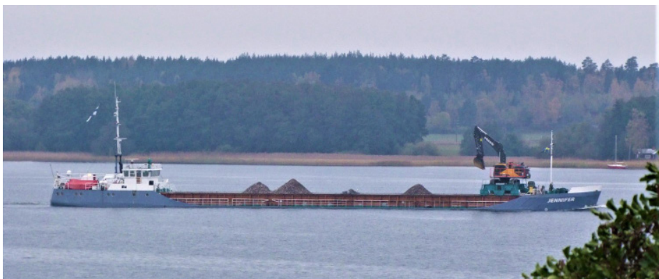
M/S Jennifer är registrerad i Borgå i Finland. Den är byggd 1984, och lastar 2000 ton. Hon är den största båten i sällskapet, 79 m lång och 10 m bred.
